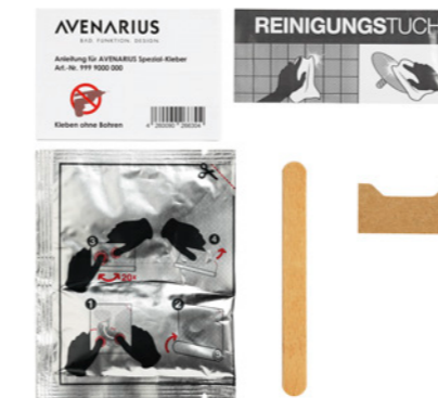
999 9000 000 Spezial-Kleber für Bad-Accessoires bestehend aus: Anleitung, Reinigungstuch, Beutel mit Kleber (2 Komponenten), Spachtel, Fixierhilfe Aushärtezeit 4 Std. Zugbelastung 90 kg/7 cm 2 Hebelbelastung (5 cm) 15 kg/7 cm 2 special adhesive for bathroom- accessories
