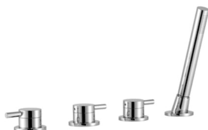
280 6175 010 Wanne-Brause-Batterie 4-Loch mit Brause mit Keramik-Innenoberteilen 90° mit separater Umstellung eigensicher gegen Rückfließen Ventil Kaltwasser linksschließend Ventil Warmwasser rechtsschließend Montageplatte und Montagegestell s. Seite 33 bath-shower mixer
