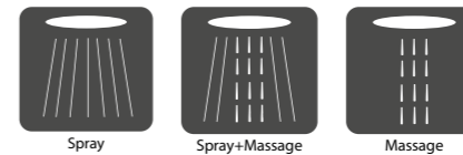
900 7361 010 Handbrause 3-fach verstellbar mit Umstellung per Druckknopf Kunststoff verchromt hand shower
