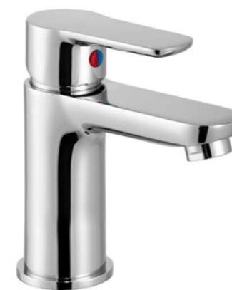
180 6000 010 Waschtisch-Einhebelmischbatterie mit Keramik-Kartusche mit Ablaufgarnitur 1 1/4" mit Flexschläuchen 3/8" single lever basin mixer
