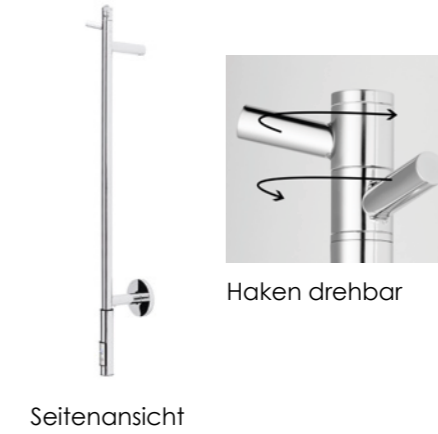
905 5200 016 Handtuchwärmer 850 mm mit 2 drehbaren Haken 12 Watt, 230 V, 50 Hz, max. 55 °C mit Timer programmierbar mit Kabel 120 cm, Stecker, auch für Direktanschluss geeignet towel heater
