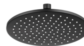
900 6917 040 NEU Regenbrause 250 x 8 mm Messing mit Kugelgelenk 1/2" Durchfluß bei 3 bar = 12,0 Liter/min. mit Begrenzer = 8,0 Liter/min. rainshower
