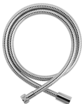
990 7333 010 Metall-Brauseschlauch 1.600 mm premium mit Drehkonus 1/2 " x Rändelmutter 1/2" und Knickschutz metal shower hose
