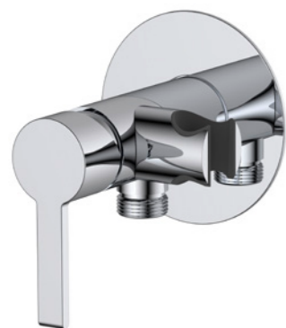
230 6255 010 Brause-Einhebelmischbatterie mit Brausehalter mit Unterputz-Einbaukörper 1/2" mit Keramik-Kartusche single lever-shower mixer
