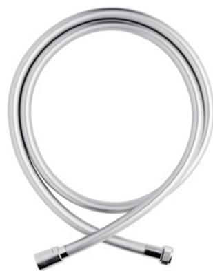
990 7309 010 Kunststoff-Brauseschlauch 2.000 mm chrom line mit Drehkonus 1/2" x Rändelmutter 1/2" und Knickschutz plastic shower hose
