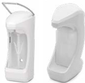
**RX5M** manueller Kunststoffspender zur Wandmontage für Flüssigseifen und Händedesinfektionsmittel, optional geeignet zur Montage an Wand und Säule. Er verfügt über eine austauschbare Kunststoffpumpe und ist kompatibel zur Einweg-Hygieneverpackung. Die durchschnittliche Dosiermenge beträgt 1,5 ml/Hub. Der Spender ist nicht abschließbar, ein Schalenhalter ist inklusive.
