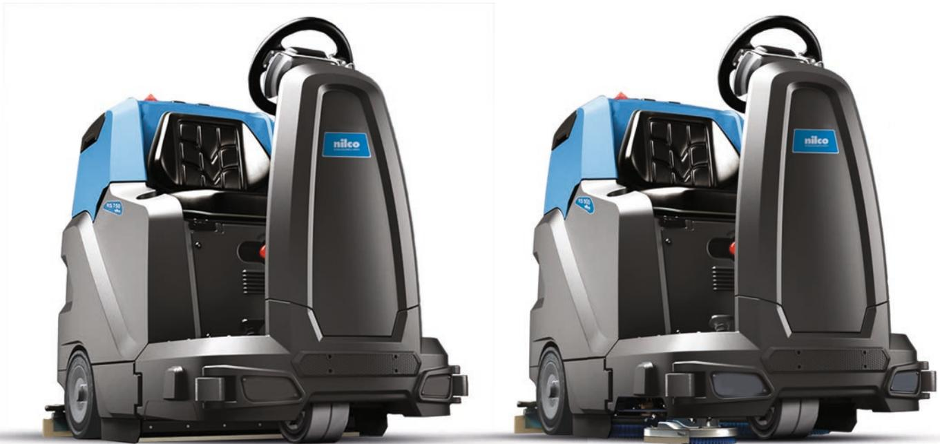
Ein zusätzliches Seitenschubbdeck erweitert die Arbeitsbreite der ansonsten mit der RS 750 baugleichen RS 900 beim Schrubben auf 85 cm. Die pendelnd gelagerte 260 mm-Tellerbürste erhöht die Effizienz der RS 900 um 15 % und reinigt auch Ränder und Kanten gründlich.
