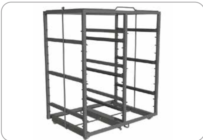
CI-IRA64-2 (2-reihig) zur Aufnahme von Modulen / Gitterkörben in 600 x 300 mm (BxT), 6 Paar Auflageschienen Gesamtmaße: 881 x 600 x 1040 mm (BxTxH)
