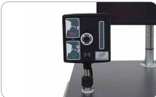
Infrarot-Wärmebildkamera mit höhenverstellbarem Stativ zur Messung der Körpertemperatur
