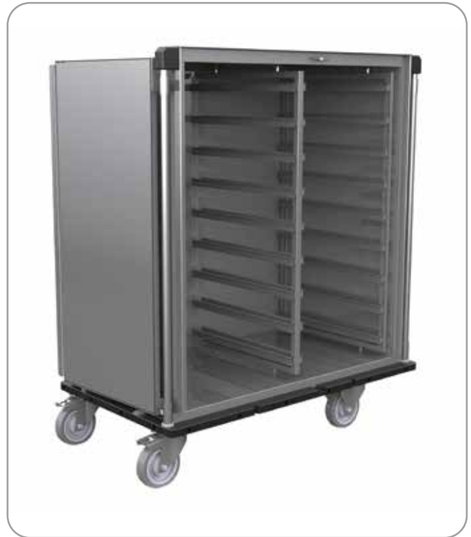
CI-STGW2-20-F Innenraum zweigeteilt für Module 600 x 400 mm 2 x 10 Paar Auflageschienen, Abstand je 125 mm Gesamtmaße: 1260 x 710 x 1470 mm (BxTxH)
